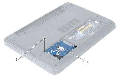
1 parafusos (2) 2 conjunto da unidade de disco rígido **3** Utilizando a patilha, levante o conjunto da unidade de disco rígido da base do computador.
