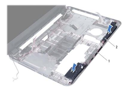
1 encaminhamento do cabo das colunas 2 colunas (2)
